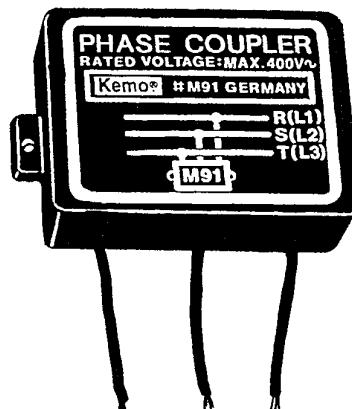
**D** Dieser Phasenkoppler M091 verbessert die Übertragungsqualität von drahtlosen Wechselsprechanlagen, wenn die Hausinstallation unterschiedliche Phasen des Drehstromnetzes benutzt. Der Phasenkoppler steigert die kapazitive Kopplung des Leitungsnetzes erheblich und damit die Reichweite und Übertragungsqualität der drahtlosen Wechselsprechanlagen.
